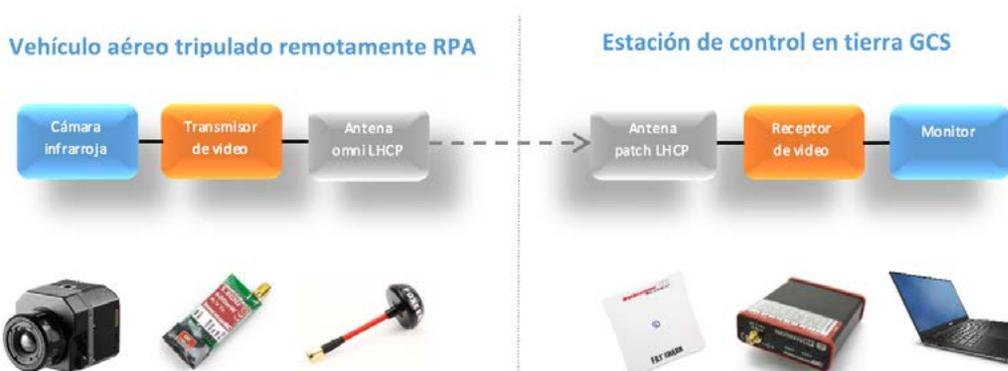
**Figura 8.** Sistema de transmisión de video en tiempo real.
